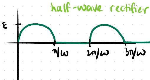
$$f(t) = \begin{cases} E \sin \omega t, & 0 < t < \pi/\omega \\ 0, & \pi/\omega \leq t \leq 2\pi/\omega \end{cases}$$
